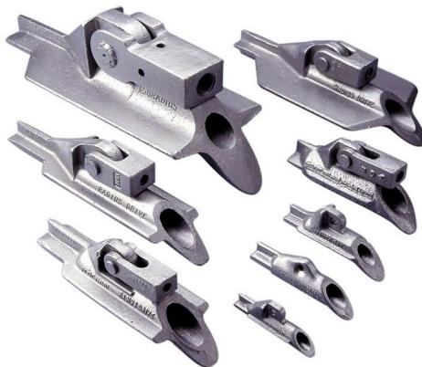
Près de 400 ancre Manta Ray furent enfoncées à 3m de profondeur dans une couche de glaise assez rigide à un angle de 20° et cachées derrière les murs. Les ancre de 6mm en acier inoxydable furent ensuite sécurisées à des barres longitudinales, positionnées dans les blocs de pierre au fur et à mesure que les murs étaient construits, et soumis à une tension de 10Kn.
