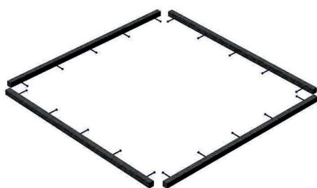
**Les lambourdes** doivent être fixées sur une bordure béton afin de servir de support pour les CityGrate®.
